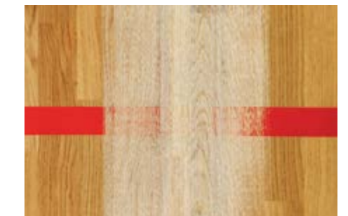
El polvo resultante de lijar con productos de la competencia, muestra evidencia de desgarro de las fibras
